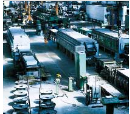
Сквозные печи Continuous annealing furnaces
